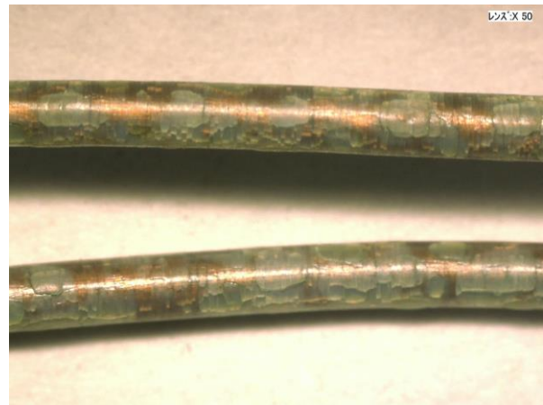
写真2 センサ線の絶縁被膜亀裂状況
