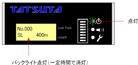
図-10. 電源立上げ時の動作
