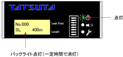
図-10. 電源立上げ時の動作
