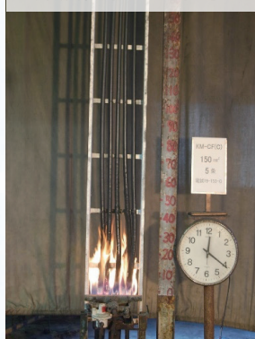
難燃試験中の様子
