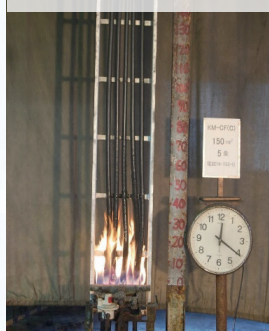
難燃試験中の様子
