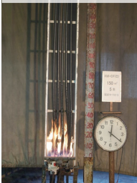
難燃試験中の様子
