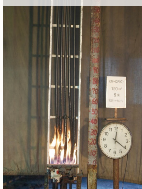
難燃試験中の様子
