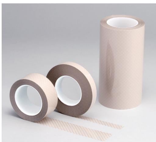
SF-FC334/374は、フレキシブルフラットケーブル (FFC) のインピーダンスを制御することが可能な熱可塑型 (ヒートシール型) の導電性フィルムです。FFCの両面に貼り合わせることで、LVDSの伝送線路に要求される差動インピーダンス100Ωを実現できるように設計されています。また、薄型・軽量設計で、FFC本来のフレキシブル性を損なうこともありません。
