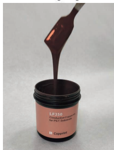
環境に優しく、大気中・無加圧で焼結可能という特長を有するCopprint社製銅ナノインク
