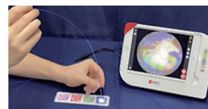
OKファイバーテクノロジー社が開発中の医療用複合型光ファイバスコープ(左)とポータブル内視鏡(右)
