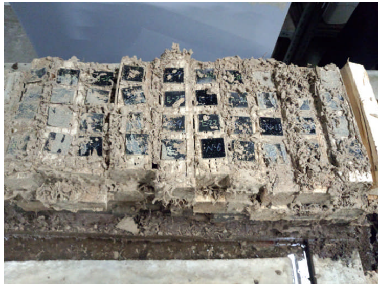
写真5 試験状況（餌木の上に試験試料を置く）
