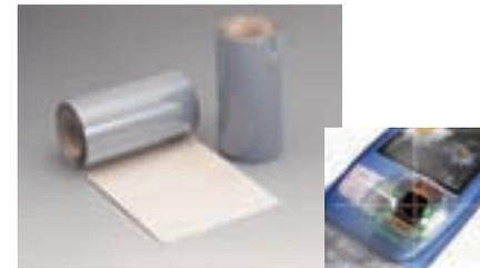
これまでの「SF-PC5000」の機能を損なうことなく、接着剤樹脂を高難燃化したハロゲンフリーのシールドフィルム。さらに業界初総厚8ミクロンという超薄型を達成。シールド特性、機械特性、物理特性、各種信頼性およびFPC加工条件はPC5000と変わらず、高撓動性、高屈曲性に加え、安全性や環境配慮が要求される用途に最適です。
