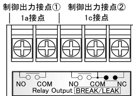
図 2 制御出力接点の出力端子
