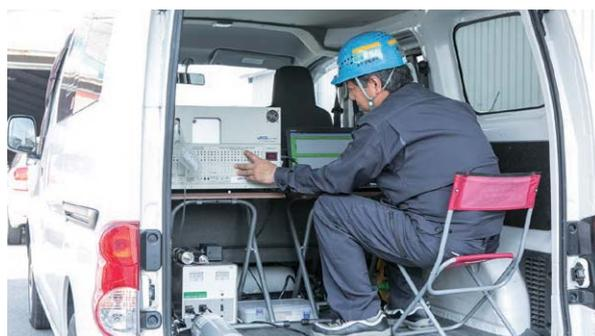
可搬式ガスクロマトグラフ-光イオン化検出器(GC-PID)
