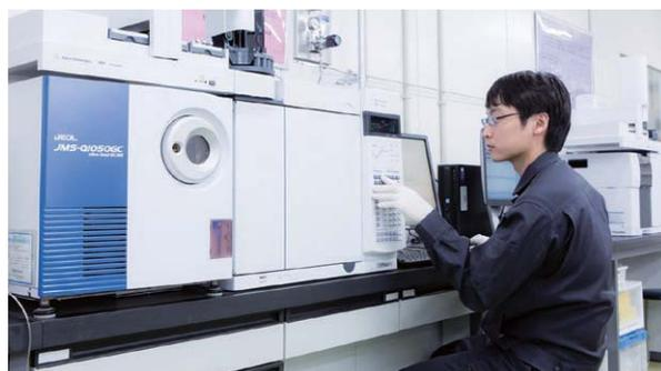
負イオン化学イオン化-ガスクロマトグラフ質量分析計(GC/NICI-MS)
