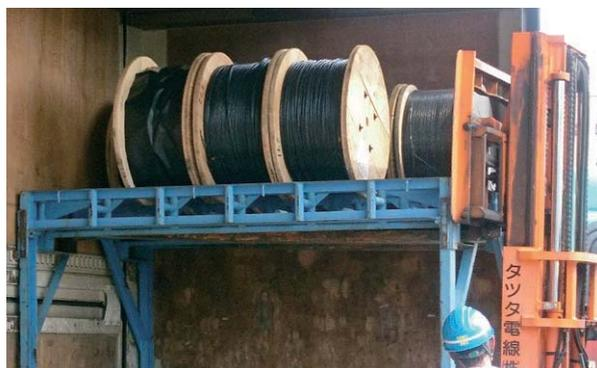
ドラムを効率良く積むための架台
