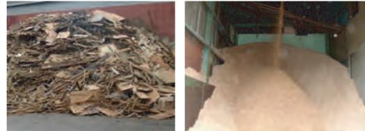
廃棄物処理委託先での環境調査。廃材(写真左)を粉砕し燃料チップとして再利用(写真右)。
