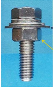
ボルトの応力腐食割れ
