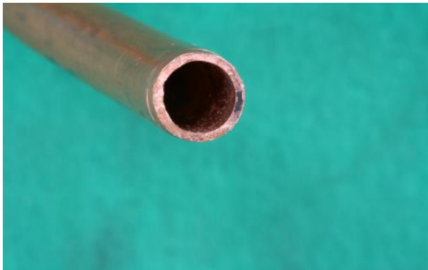
割れ破損銅管
